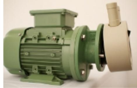
7. Pumpengehäuse bis an den Flansch nach schieben. Die Führungsstifte des Flansches müssen sicher in die Passlöcher des Pumpengehäuses passen. (ggf. dabei etwas am Gehäuse wackeln).
