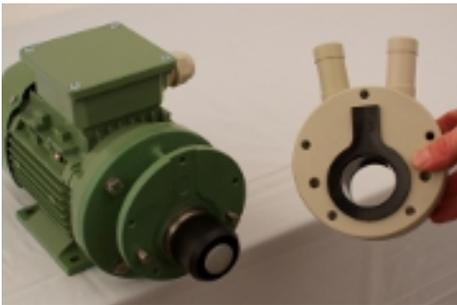
5. Pumpenbalg auf der Gegenseite wieder ca. zu 1/3 aus dem Pumpengehäuse heraus drücken.
