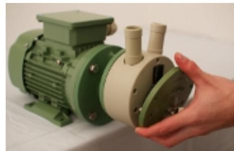
10. Gehäuseschrauben mit Scheiben bis zum Anliegen an der Deckplatte eindrehen und über Kreuz gleichmäßig anziehen.
